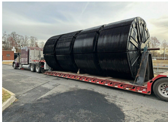
Nuevos Contactores Biológicos Rotativos (RBC's) llegando a la planta para reemplazar las unidades averiadas.
